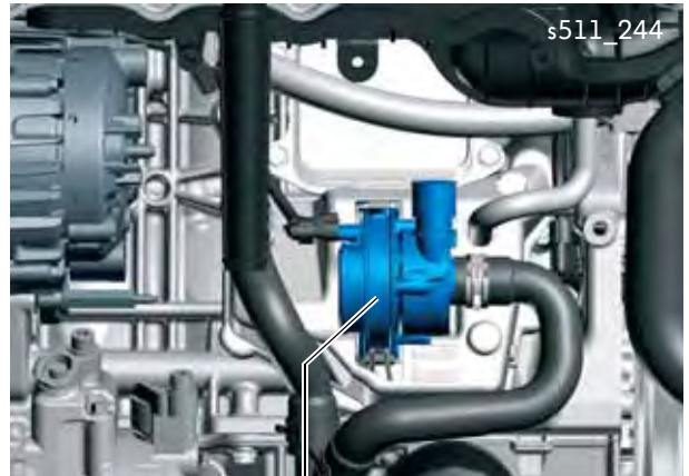
Pomp voor laadluchtkeeling V188
