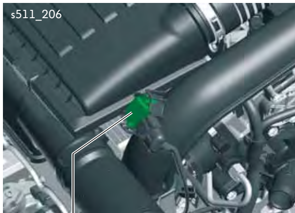
Sensor laaddruk G31 en temperatuurvoeler aangezogen lucht G42
