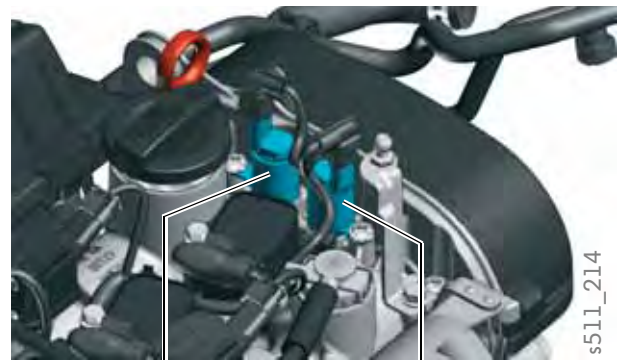
Klep 1 voor nokkenasverstelling N205
